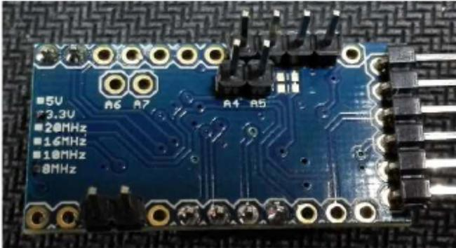
Instale un conector de 4 patillas desde GND hasta A3 por la cara inferior.
