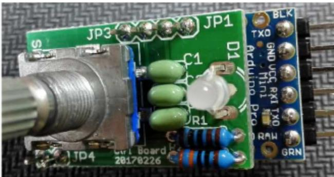
Enchufe la placa de Control en la cara superior de la placa de Arduino.
