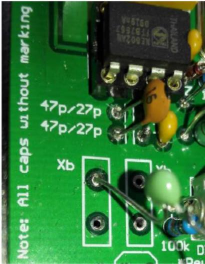
Use un condensador de 100 nF (104) para conectar JP9, isleta de la derecha, con el OFB (una de las isletas de Xa', tal como muestra la fotografía. La isleta derecha de JP9 (en la esquina) es masa (GND).
