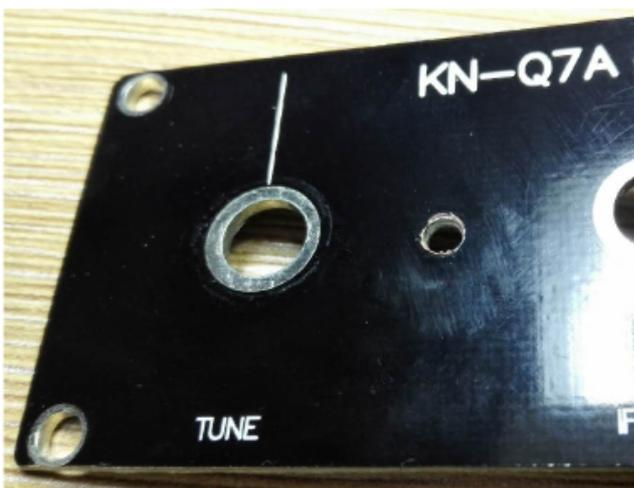
Necesitará perforar en el panel frontal un agujero de 3 mm de diámetro el led indicador. Debe hacerse en medio de los dos agujeros ya hechos en la placa para los potenciómetros.
