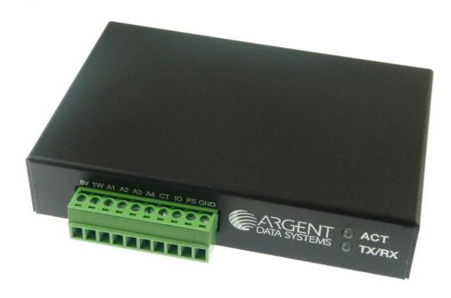
前面板有两个双色发光管,标为ACT (活动)和TX/RX (发射/接收)。可拆卸的10 脚接线柱是一个附件接口,提供一个Dallas 1-wire 数据总线、一个5V 电源、四个0到20V 模拟输入、一个计数器/发射触发输入、一个数字 I/O 脚和一个7A 固态继电器输出。
